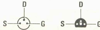
Fig. 8 Se utilizzaste 2N3819 con involucro rotondo ed anche con involucro a mezzaluna però con i terminali disposti a triangolo anziché in linea, ricordatevi che la disposizione dei terminali risulterà S-D-G anziché D-G-S.
