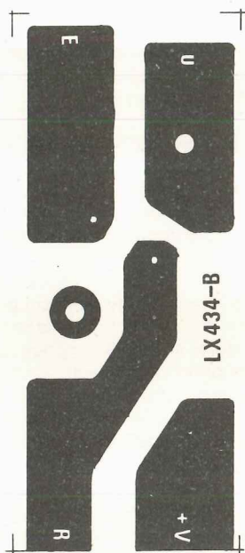
Fig. 5 Circuito stampato a grandezza naturale da fissare sotto l'aletta di raffreddamento in modo da potergli stagnare i terminali dell'LM.338K.
